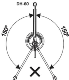
O ajuste da posição do Headset **DH-60** (direita ou esquerda) deve ser efetuado girando o **Articulador do Microfone HZ-30** a um limite de **300°**, sempre passando pela **Tiara**.
