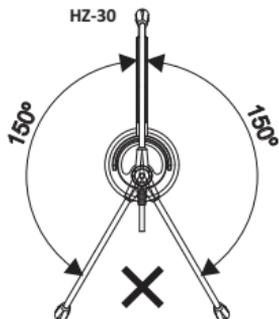
O ajuste da posição do **Headset HZ-30** (direita ou esquerda) deve ser efetuado girando o **Articulador do Microfone HZ-30** a um limite de 300°, sempre passando pela **Tiara**.
